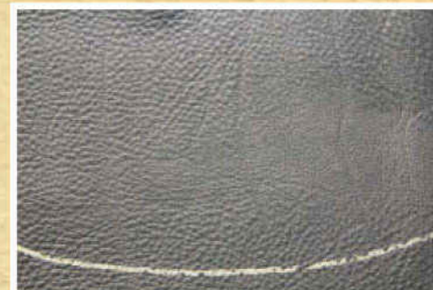
„A“ Sima gerinc, nyaki ránc smooth spinal leather with neck creases glattes Leder aus der Grotzenseite mit Nackenfalten
